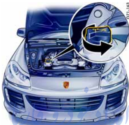
Engine oil filling point on Cayenne S, Cayenne GTS, Cayenne S Transsiberia
